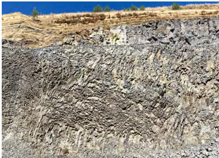
Foto 2. Colata lavica di tefrite leucitica di aspetto basaltico oggetto di coltivazione di cava
