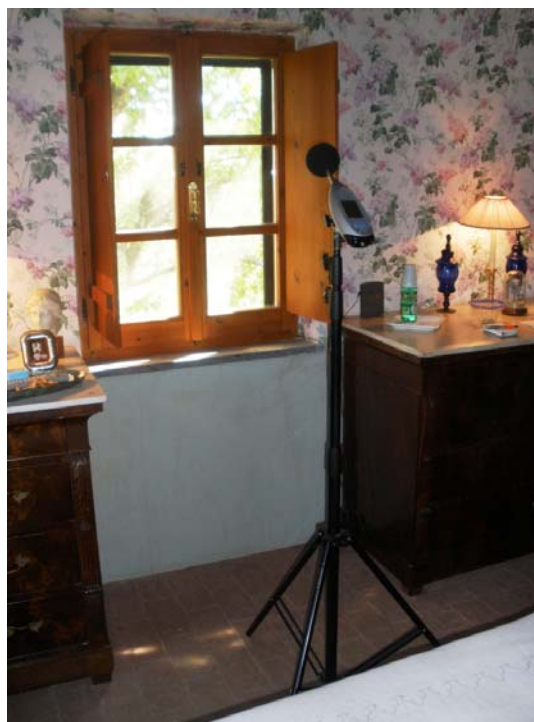
Foto 7 e 8: Vista del punto di misura durante la verifica del criterio differenziale.
