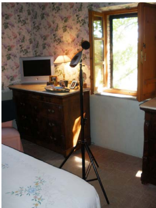
Foto 7 e 8: Vista del punto di misura durante la verifica del criterio differenziale.
